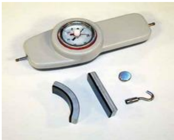
RYC. 2 Dynamometr do pomiaru siły pchania/ciągnięcia (wg www.stanley.poznan.pl )
