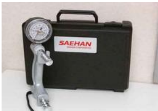
Ryc.1 Hydrauliczny dynamometr do pomiaru siły ręki (wg www.stanley.poznan.pl )
