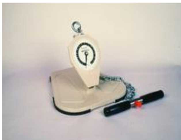
Ryc.3 Dynamometr do pomiaru siły mięśni pleców, nóg i klatki piersiowej (wg www.stanley.poznan.pl )
